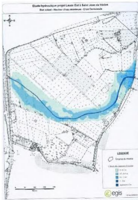
Figure 16 - cartographie des zones inondables centennales sur le secteur Est de l'aire d'étude (Egis, 2014)
